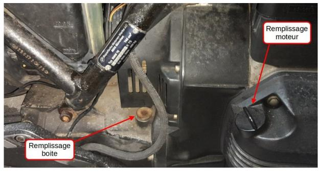
Tapez un coup sec avec un marteau bien a plat sur le bouchon de remplissage pour décoller les filets.
