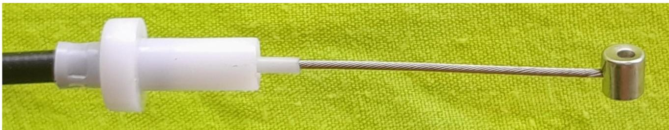
L'embout plastique s'enfile dans le logement tubulaire fendu de la plaque triangulaire dont le modèle a pu varier au fil des années.
