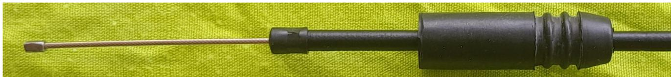
s'y ajoutent une vis creuse de réglage et son contre écrou et la douille creuse taraudée qui sert de support dans la cocotte droite.
