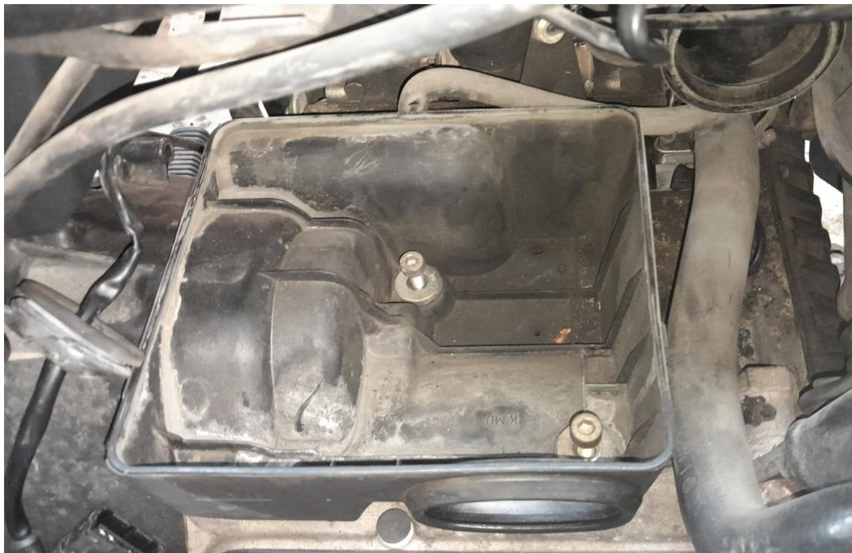
Avec une clé allen de 6 mm retirez les deux vis BTR de 8x30 mm qui maintiennent la partie inférieure du boîtier sur des silent blocs . ne perdez pas le petit joint torique , les rondelles , l'entretoise ou le silent bloc.
