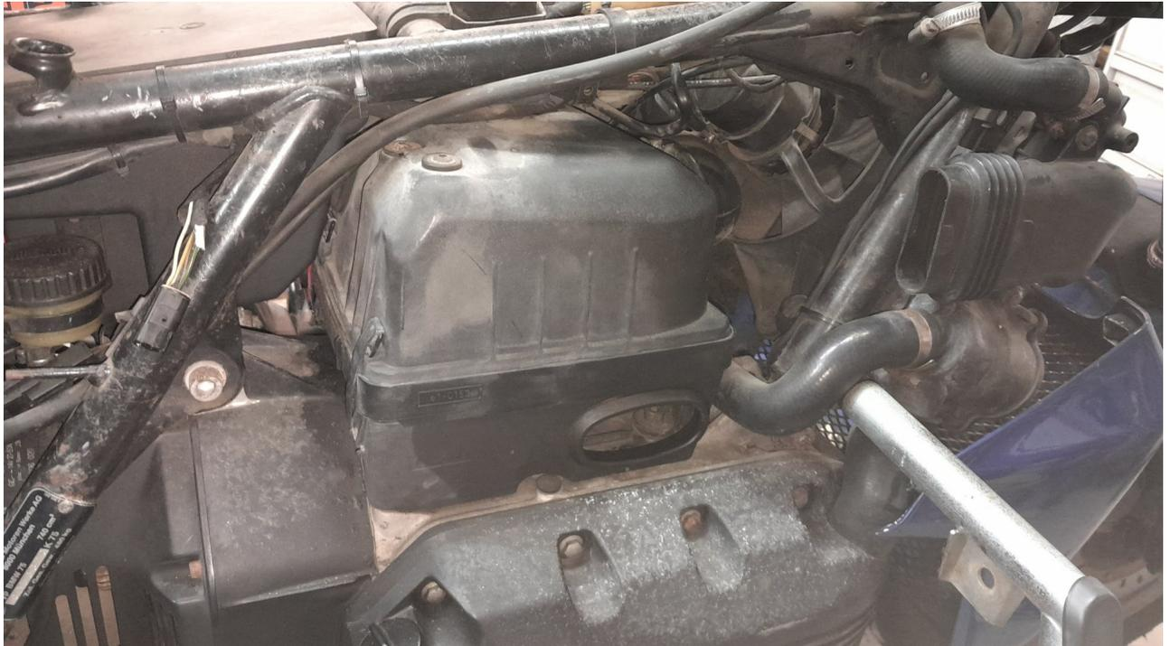
La partie supérieure du boîtier de filtre à air contenant le débitmètre est aussi retenue par un coude allant vers le collecteur d'air de la tubulure d'admission des papillons et par le fil de la prise d'alimentation du débitmètre.
