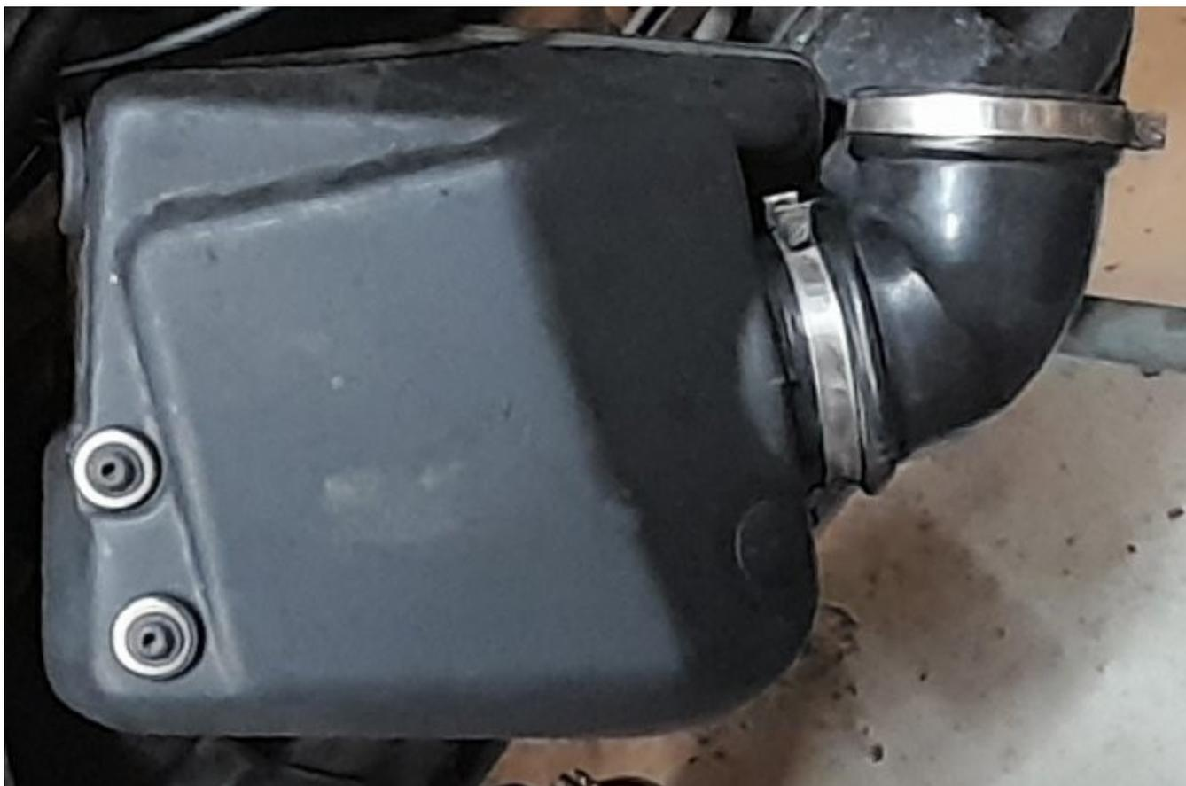
Installez un serflex sur l'autre extrémité du coude dans le bon sens pour qu'il puisse être serré "facilement ?" par dessus : la vis doit être en avant du coude et accessible par le haut.
