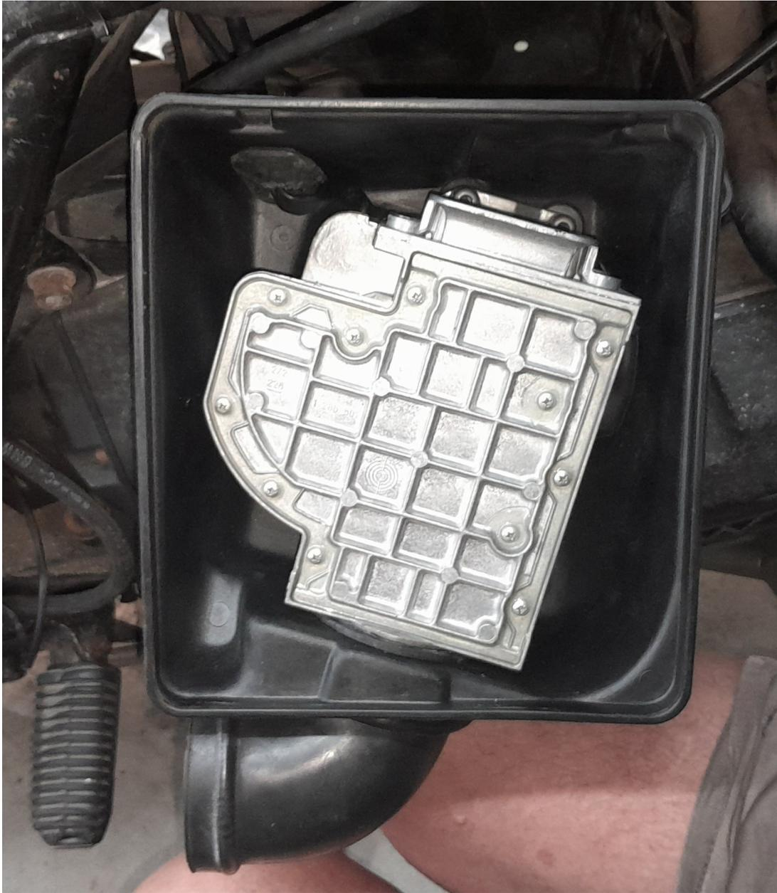
Avec une clé allen de 4 mm , montez et serrez les deux vis BTR 6x20 mm de fixation du débitmètre au couple de 6 +/- 1 Nm.
