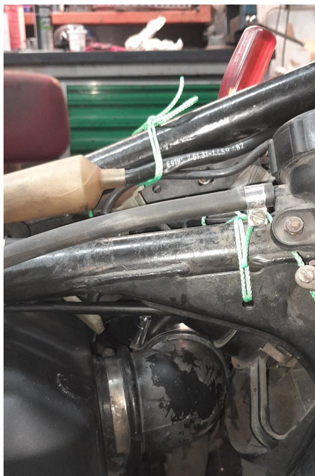
Emmanchez les trois éléments de la prise d'air l'un dans l'autre et dans la partie inférieure du boîtier de filtre à air , une lubrification à l'eau des caoutchoucs peut aider.
