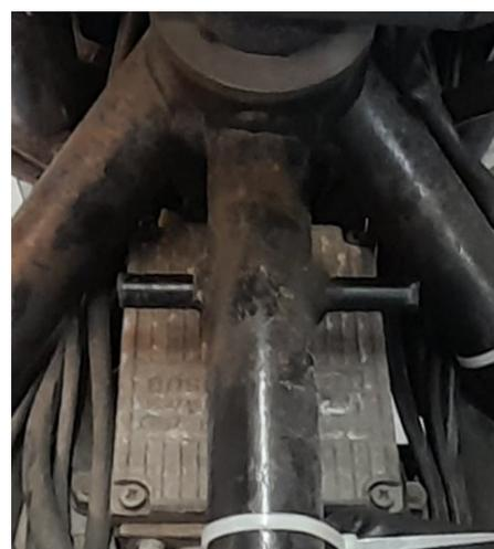
Les tampons de caoutchouc fixant le réservoir ont un diamètre de 33 mm pour une hauteur de 30 mm, leur largeur totale est de 95 mm.
