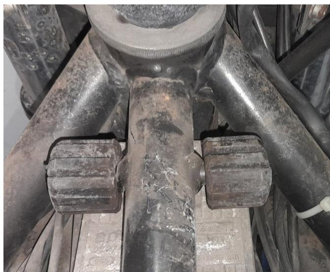
A l'arrière le réservoir est posé sur des plots caoutchouc fixés au cadre.
