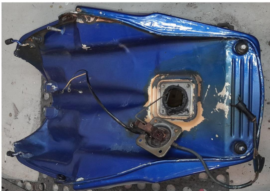
Parfois le nettoyage mettra en évidence des trous dus à la corrosion et il faudra soit changer le réservoir en aluminium , soit le faire réparer : voir les articles du forum consacrés à ce sujet.
