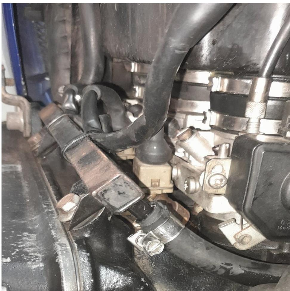
La durite branchée sur le réservoir plus en avant sert au retour de l'essence venant du régulateur de pression d'injection qui n'est pas visible car situé derrière la rampe d'injection , cette durite part verticalement du sommet du régulateur d'injection.
