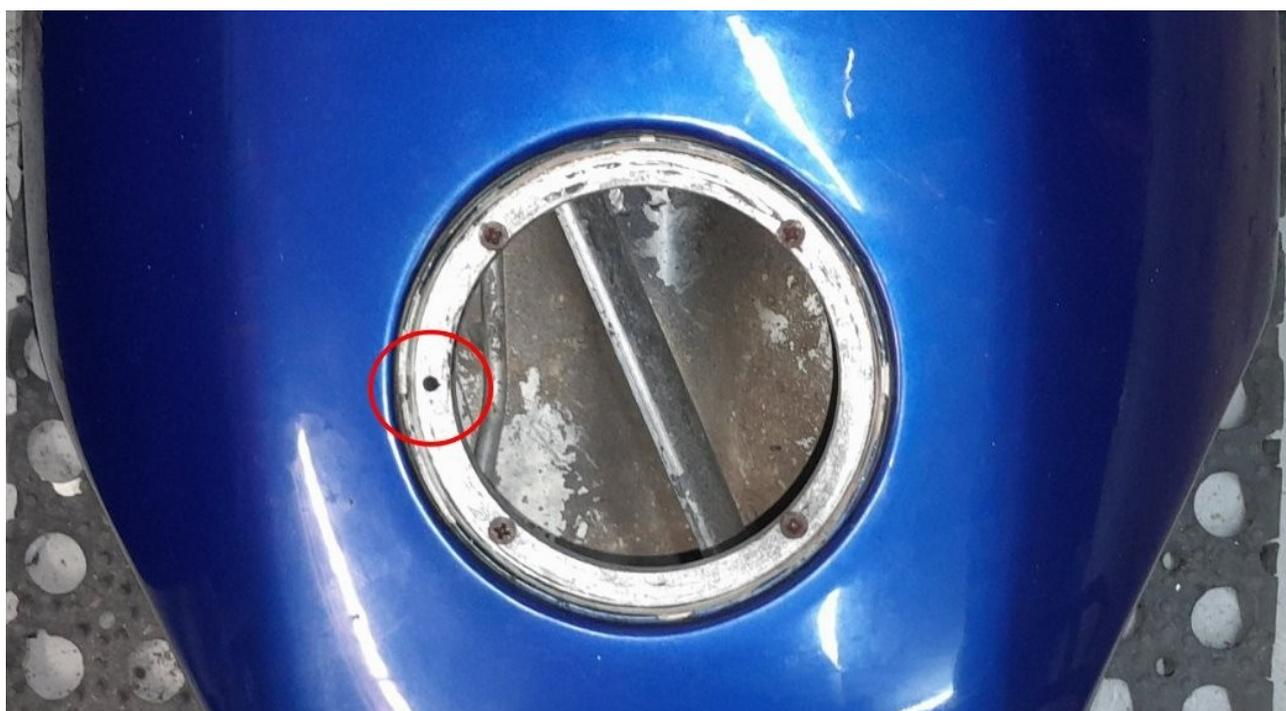
Ces tuyaux se vident dans un réceptacle fixé au cadre situé juste en dessous et dont le tuyau d'évacuation débouche vers l'axe du bras oscillant à proximité du tuyau d'évacuation de la batterie.
