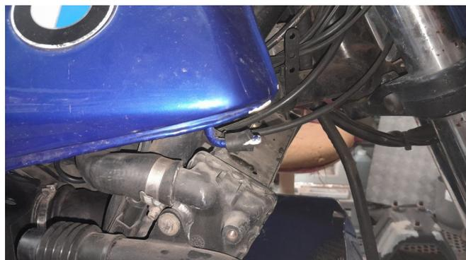
Les demi carénages de radiateur D et G sont fixés à l'arrière par des plots qui viennent s'engager dans des œillets caoutchouc fixés au réservoir.
