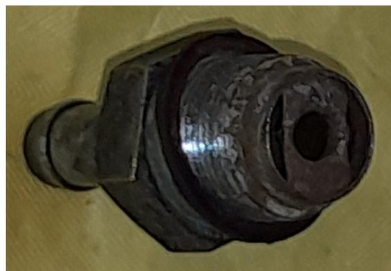
Pour des raisons de corrosion il est sans doute préférable d'utiliser une rondelle d'étanchéité en aluminium plutôt qu'en cuivre sur un réservoir en aluminium.
