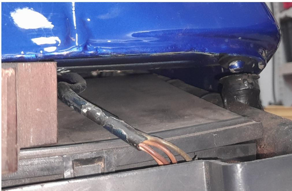
Débranchez les durites situées du côté gauche sous le réservoir , c'est plus facile que de les débrancher au niveau de la rampe d'injection car ainsi elles gardent leur trajet.
