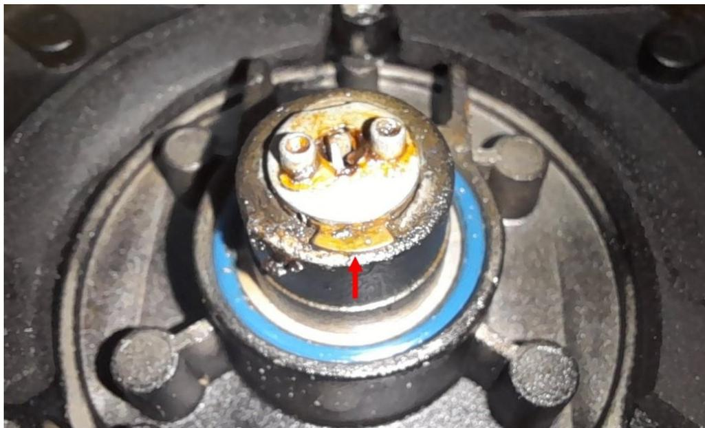
Sur la partie démontée on retrouve le loquet de fermeture avec son ressort de rappel et on voit bien la came en spirale qui l'actionne.
