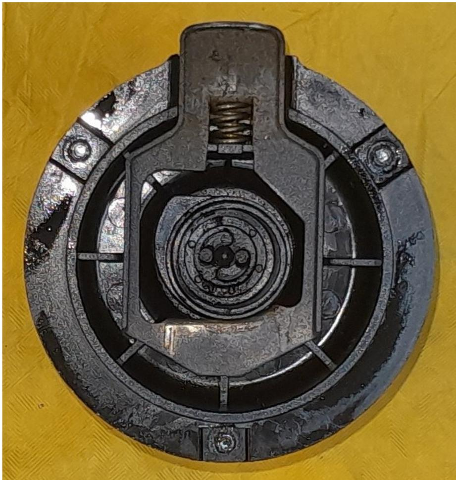
Une vue agrandie montre les deux petits trous dans la pièce plastique qui permettent l'entraînement de la came en rotation par les deux ergots visibles plus haut. C'est une partie fragile.
