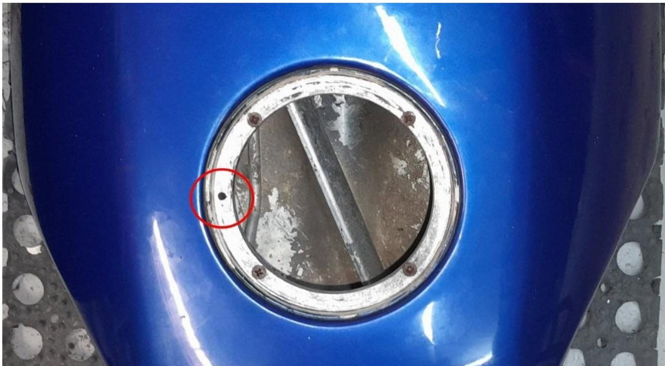
La dépose de la trappe de remplissage du réservoir est nécessaire pour intervenir sur la pompe à essence , le filtre ou la jauge de carburant.
