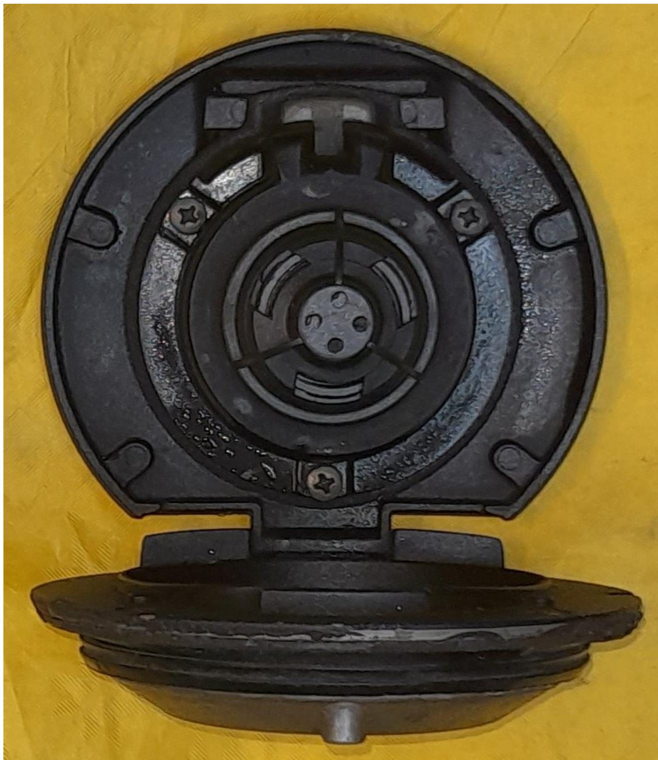
Une fois démonté , on tombe sur le barillet avec l'extrémité de la clé et les deux petits ergots d'entraînement du mécanisme de verrouillage du bouchon
