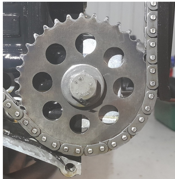
pignon du bas (aac échappement)
