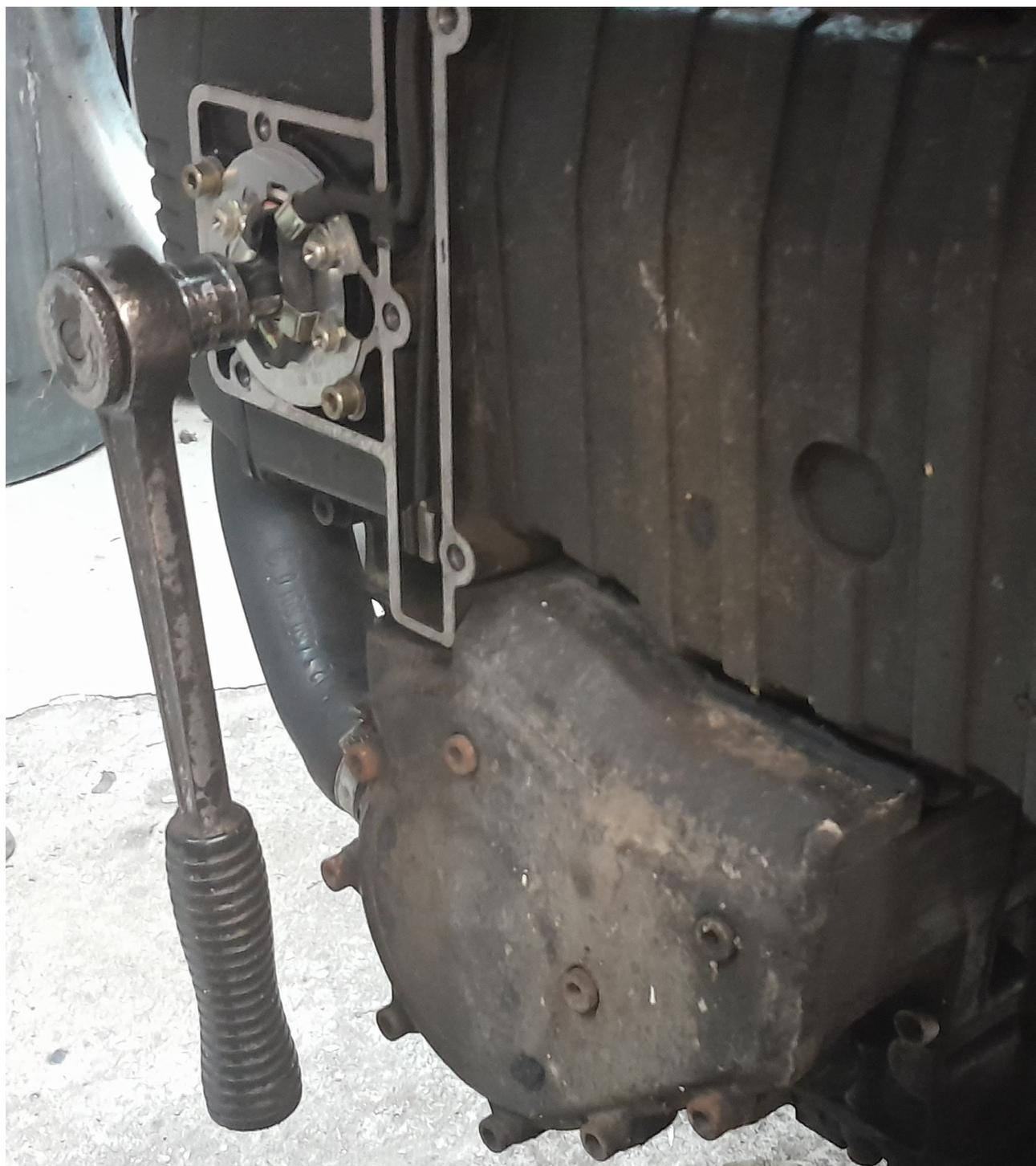
Avec une douille de 10 mm retirez les 10 vis de fixation du couvre culasse
