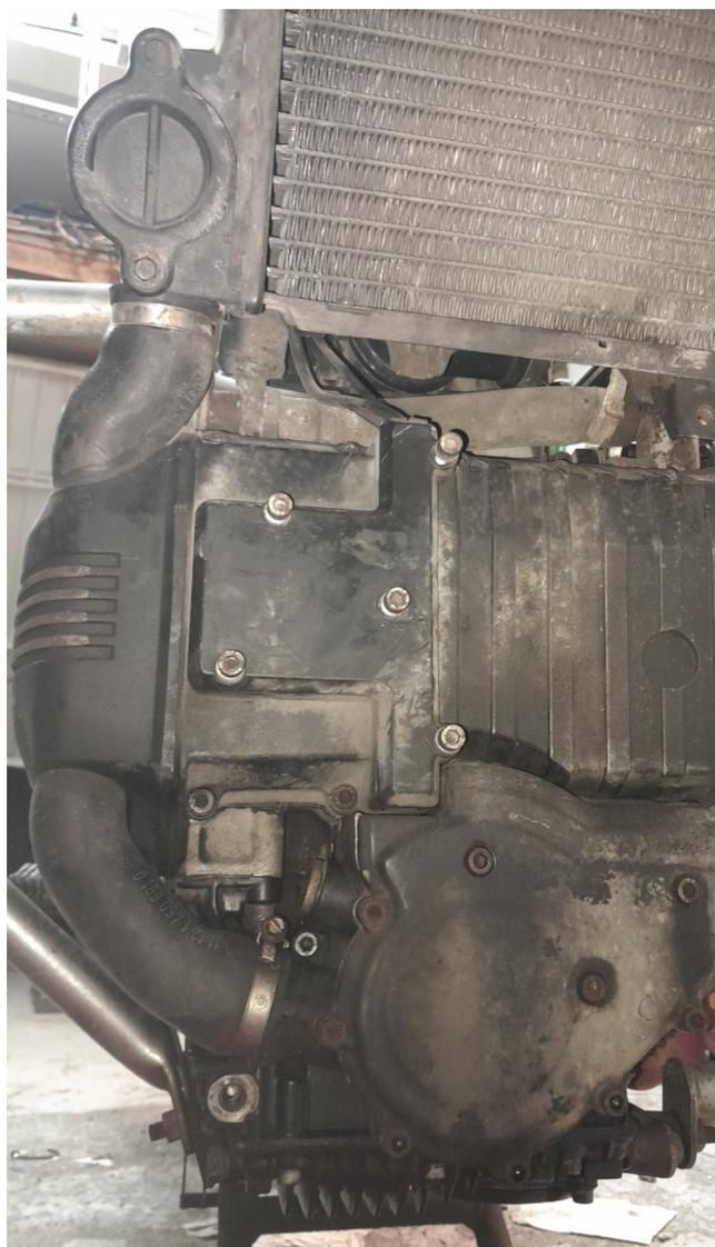
Une douille Allen de 8 mm avec une clé à cliquet permettra de faire tourner le vilebrequin
