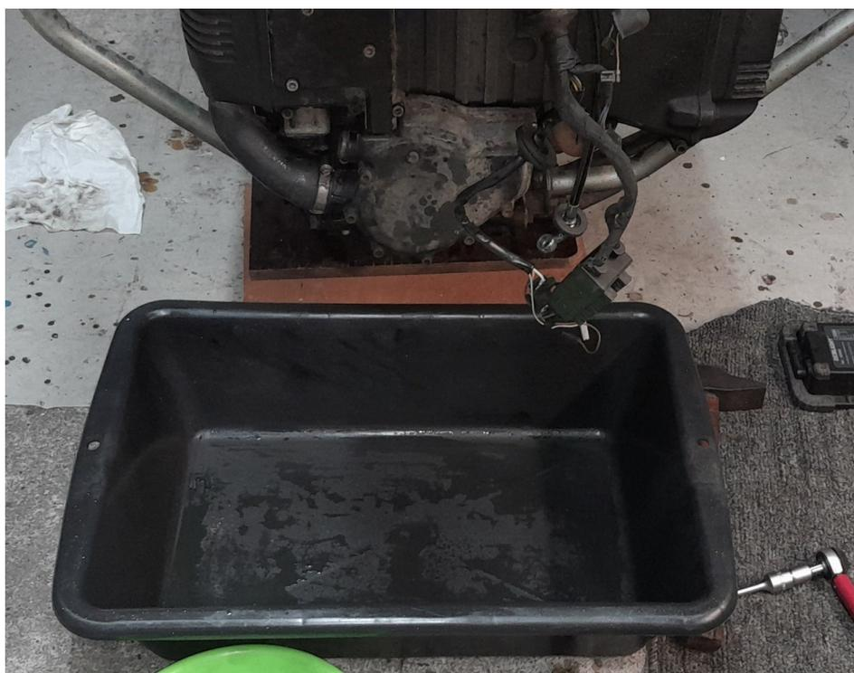
Avec une douille Allen de 5 , tapez un coup sec sur le bouchon de vidange et dévissez ce bouchon fileté de 10x8 et récupérez le joint.cuivre de 13,5x10x1.
