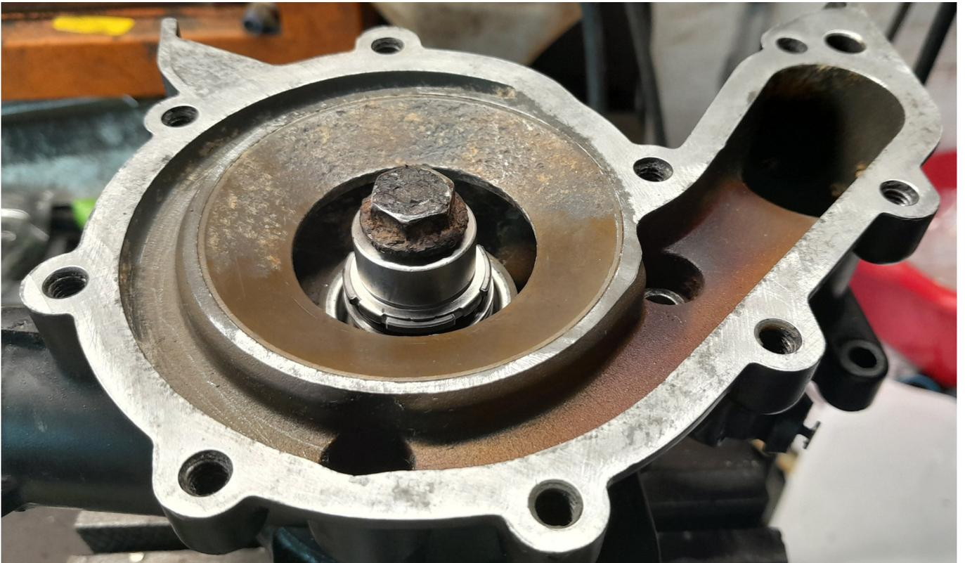
On démonte la vis pour voir l'avancée de l'arbre , on est bientôt en butée dans l'entretoise.
