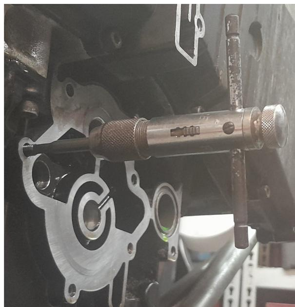
Démontez le clapet de décharge de surpression d'huile et nettoyez le
