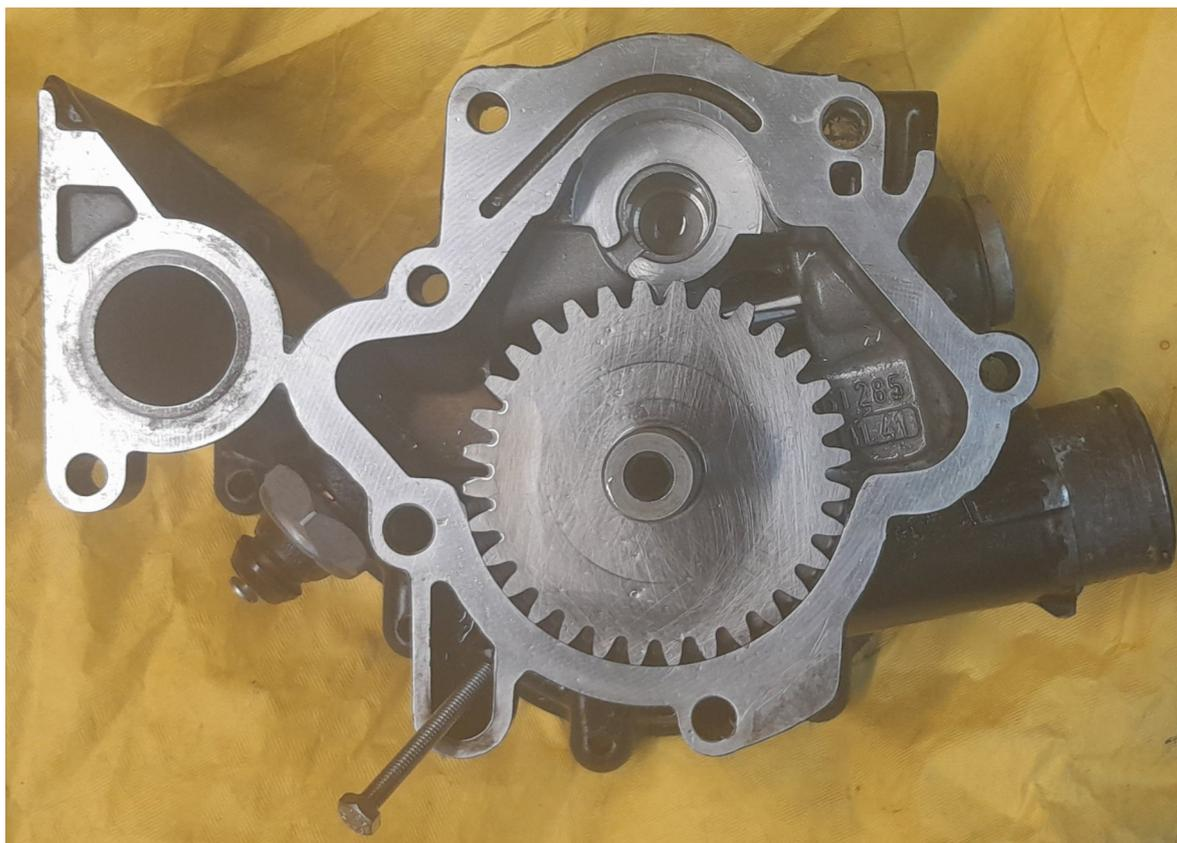
N'hésitez pas à nettoyer les différents taraudages dans le corps de pompe et le carter moteur avec un taraud de 6x100.
