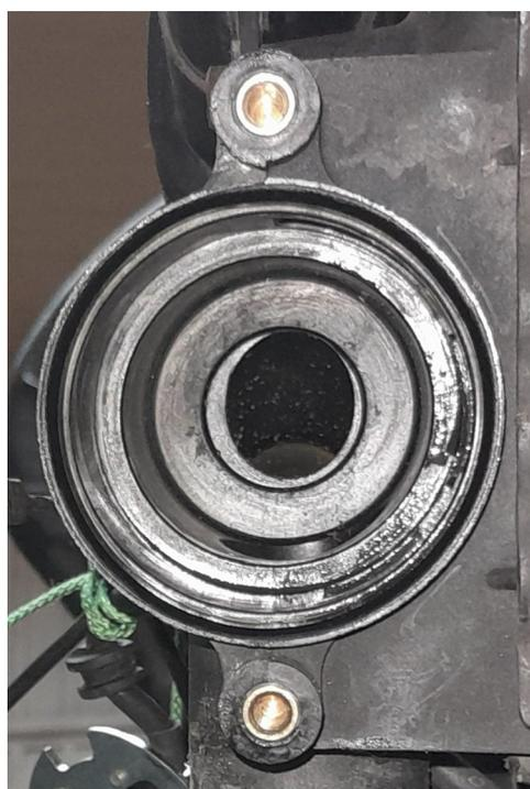
Enfilez le thermostat muni de son joint rainuré. La partie plate du thermostat dans le fond, la partie bombée vers le couvercle.
