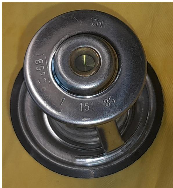
On peut tester le fonctionnement du thermostat en le mettant dans une casserole d'eau avec un thermomètre , en chauffant progressivement et en observant les déformations du thermostat.
