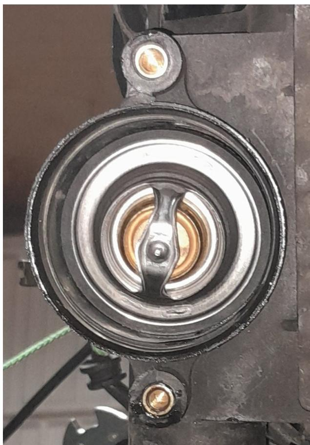
Remettez le couvercle et avec une douille de 8 mm serrez les deux vis au couple très faible de 3 Nm
