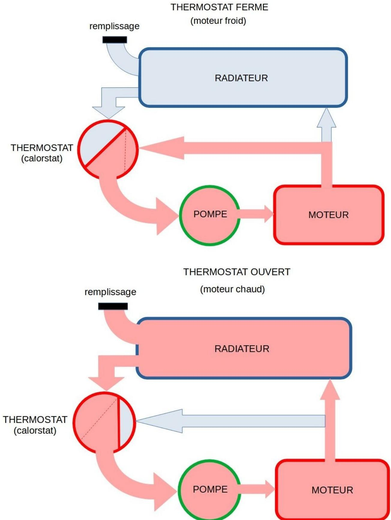
Cette régulation est obtenue par une modification de la forme du thermostat au voisinage de 85° Celsius.
