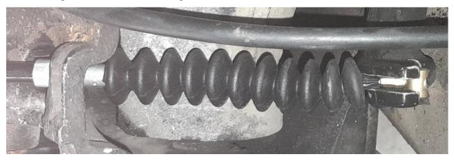
un cylindre perpendiculaire au câble d'un diamètre de 8 mm et d'une largeur de 9 mm. A la différence du tourillon de l'avant , celui ci n'est pas démontable du câble , il s'appuie sur le sertissage d'extrémité.
