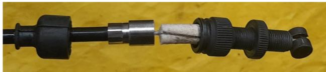
Sur le sertissage avant prend place un tourillon fendu : cylindre d'un diamètre de  $10~\rm mm$  et d'une largeur de  $11,6~\rm mm$
