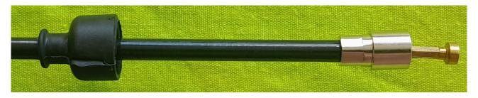
Un cylindre de feutre fendu prend place à cheval sur le câble entre l'arrêt de gaine et la vis moletée creuse de réglage , à l'intérieur de celle ci.
