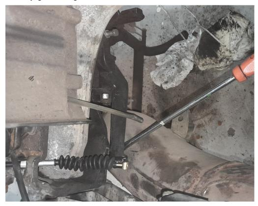
Le tourillon arrière , à la différence de celui de l'avant coulisse simplement sur le câble et ne peut être retiré.
