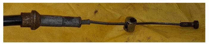
ce cylindre vient se fixer dans la fourche de la biellette d'embrayage.
