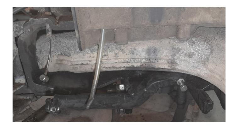
Du coté droit de la biellette d'embrayage , mieux accessible avec la roue arrière démontée on trouve une vis à tête hexagonale de 10 mm munie d'un contre écrou de 13 mm mince.
