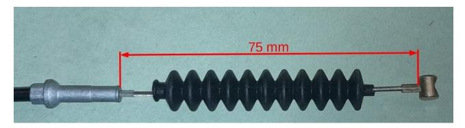
Cette distance est obtenue en dévissant progressivement au guidon la vis moletée noire creuse jusqu'à obtention d'une cote de 75 mm.
