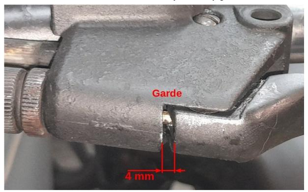
Une fois ce résultat obtenu, serrez le contre écrou avec la clé à œil de 13 mm en maintenant la vis avec la clé à douille de 10 mm.
