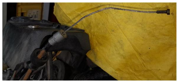
un tourillon fendu qui se loge dans le levier d'embrayage. l'axe du levier avec la bague et le contre écrou.
