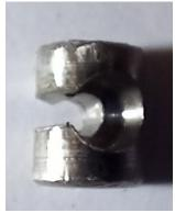
le levier par dessous avec l'ancienne bague nylon en place
