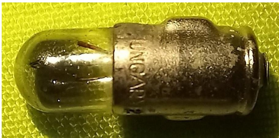
Les neuf ampoules d'éclairage pour les voyants de 12 V 1,7 W ou 14 V 3W
