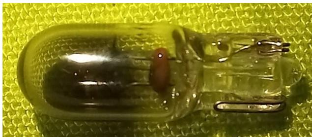
Une ampoule d'éclairage pour la montre 12 V 1,7 W
