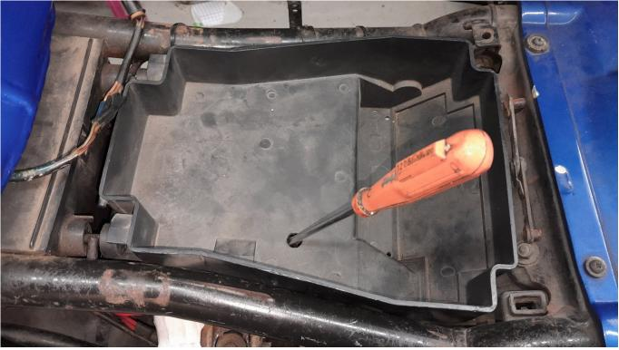
Une fois la prise débranchée , vous pouvez sortir facilement le bac en l'inclinant latéralement , il repose simplement sur 4 silent blocs qu'il ne faudra pas faire tomber au remontage , ils sont simplement enfilés sur des tiges métalliques.
