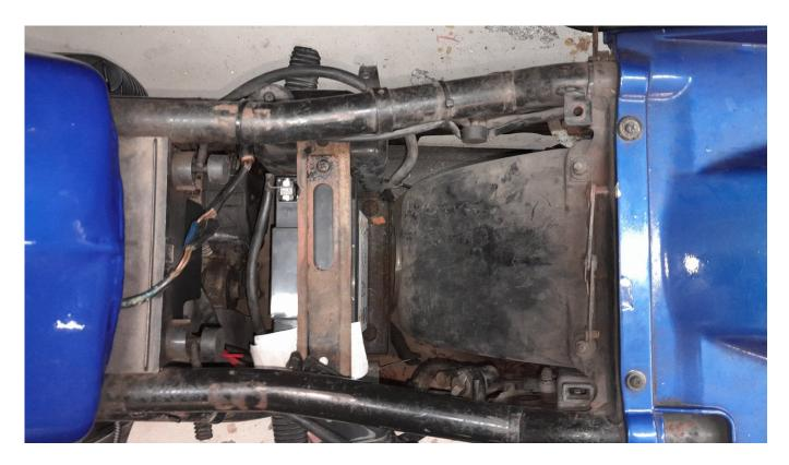
Il ne reste plus qu'à retirer avec un tournevis cruciforme les deux vis longues (diamètre = 5 mm, longueur = 180 mm) qui maintiennent la bride supérieure de maintien de la batterie (glissière) pour avoir accès à la cosse négative de la batterie. Ne pas perdre le tampon (silent bloc) à l'extrémité de la bride qui est en appui sur le vase d'expansion du liquide de refroidissement.
