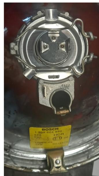
Vous pouvez ensuite retirer les deux vis de fixation latérale du bol arrière du phare après avoir repoussé le passe fil en caoutchouc qui reste sur le faisceau.
