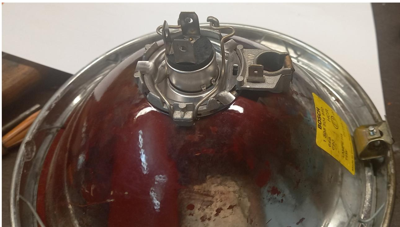
Débranchez la prise de la douille de l'ampoule phare/code , vous pourrez ultérieurement sortir l'ampoule du réflecteur pour la changer en dégageant les extrémités de la corde à piano pliée.
