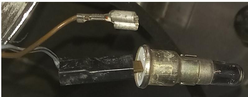
Une intervention sur le faisceau : remplacement de quelques fils coupés dus à un faisceau trop court et à des collier rilsan trop tendus.
