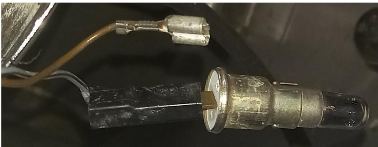
Le remplacement de la totalité du fil de la veilleuse est assez simple puisqu'il s'agit de prises plates à sertir femelle standard dont une isolée de plus grande taille ????, il ne faudra donc faire qu'une seule soudure coté faisceau.
