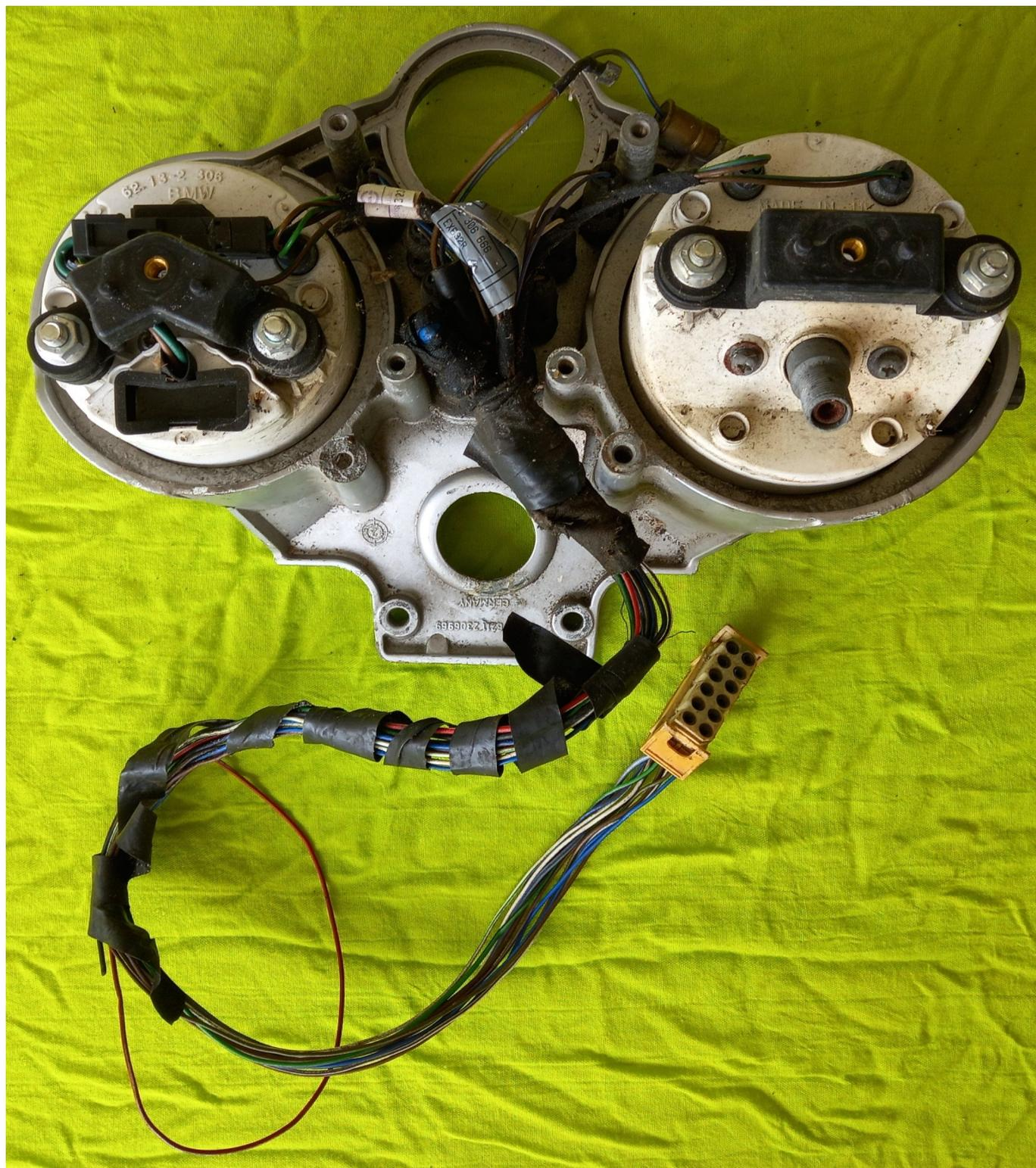
La connexion comprend une prise à trois broches et 2 douilles pour les ampoules d'éclairage du cadran du compte tour.
