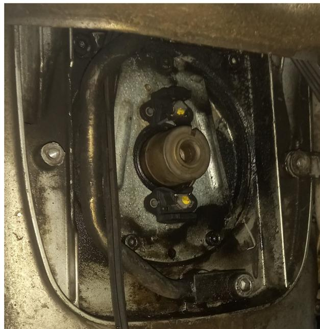
Les deux capteurs à effet Hall sont maintenant bien visibles, notez l'encoche dans l'extrémité du vilebrequin pour le calage de la cloche du capteur à effet Hall.
