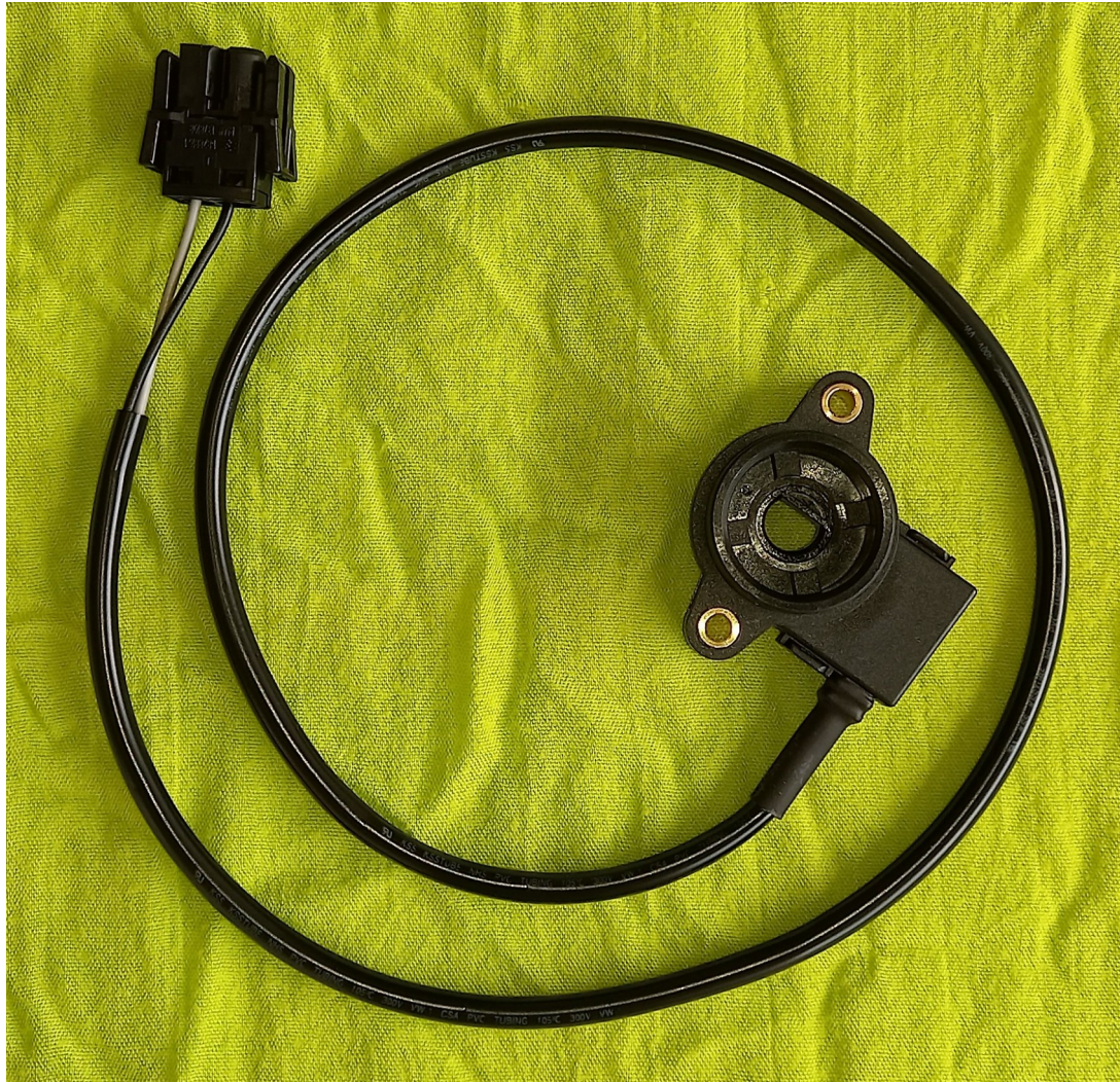
Le contacteur de point mort neuf
