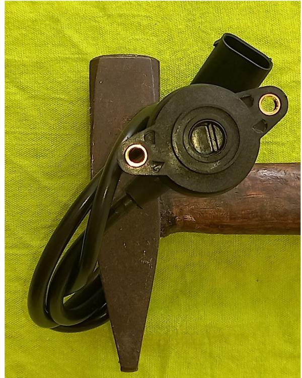
L'opération est très simple , il suffit d'insérer le nouveau capteur sur l'axe du tambour se sélection au dessus du capteur de point mort en respectant l'orientation du méplat et l'orientation des fils.
