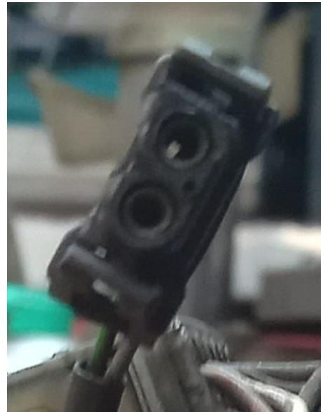
Les prises du contacteur de stop avant
