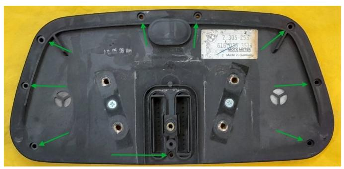
Désolidarisez la face arrière du boîtier sans abîmer le joint visible sur la photo suivante.
