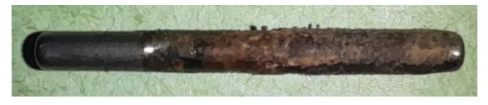
L'idéal aurait été de les remplacer par des axes en inox de 2 x 21 mm , je les ai simplement poncés à l'abrasif très fin.
