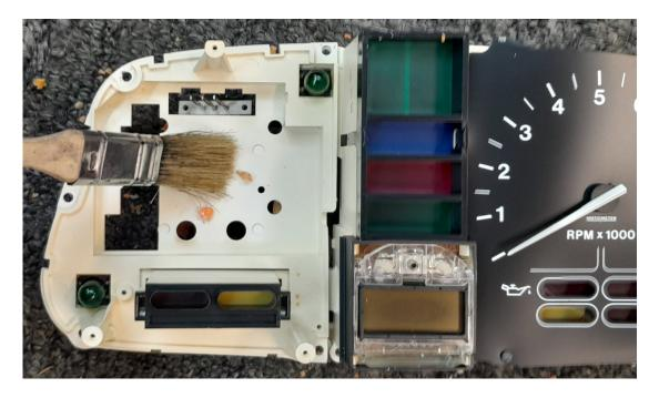
Inspectez l'odomètre pour trouver l'origine du problème, ici vu les débris de couleurs différentes un peu partout, il y avait au moins deux engrenages différents détériorés. (en fait trois).
