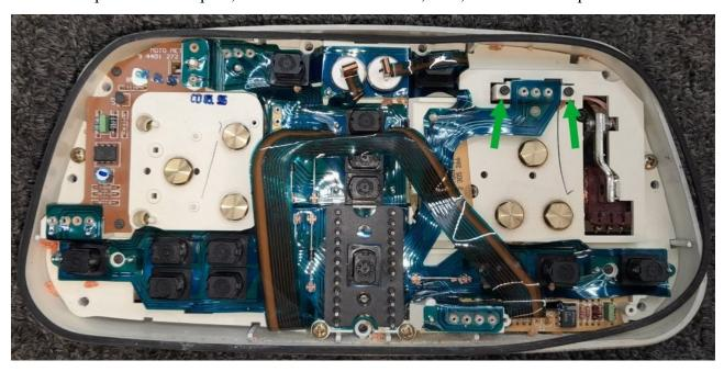
Avec une clé à douille de 10 dévissez les trois vis de 3 x 2 qui maintiennent l'odomètre. Ces vis ont un épaulement et une douille de centrage en plastique ou en caoutchouc.
