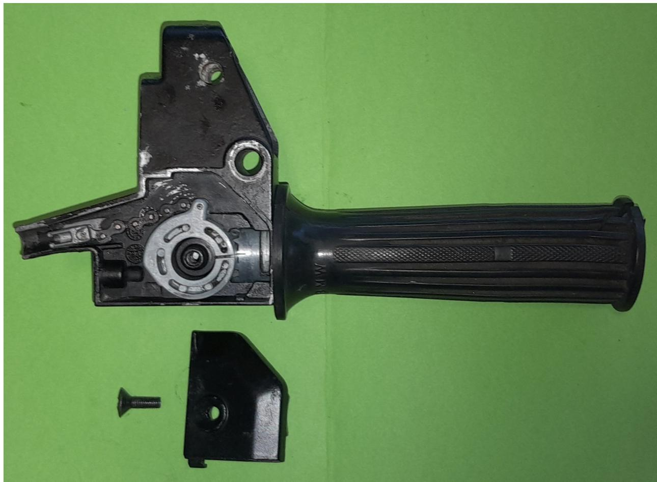
Détachez le câble de gaz de l'extrémité de la chaîne.
