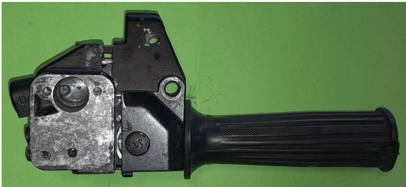
La platine du maître cylindre supporte le réservoir fixé par trois vis longues , une vis parker et un joint torique.
