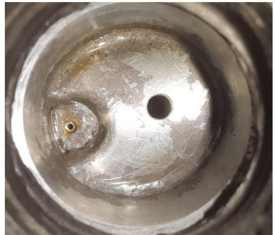
Lors de l'appui sur le levier le liquide de frein passe dans le maître cylindre en dessous par le gros trou.
