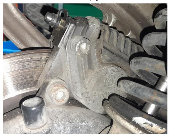
Sur ce modèle avec roues à batons et sans ABS , le système de freinage arrière est constitué d'un étrier fixe avec deux pistons de diamètre 38 mm de part et d'autre du disque.
