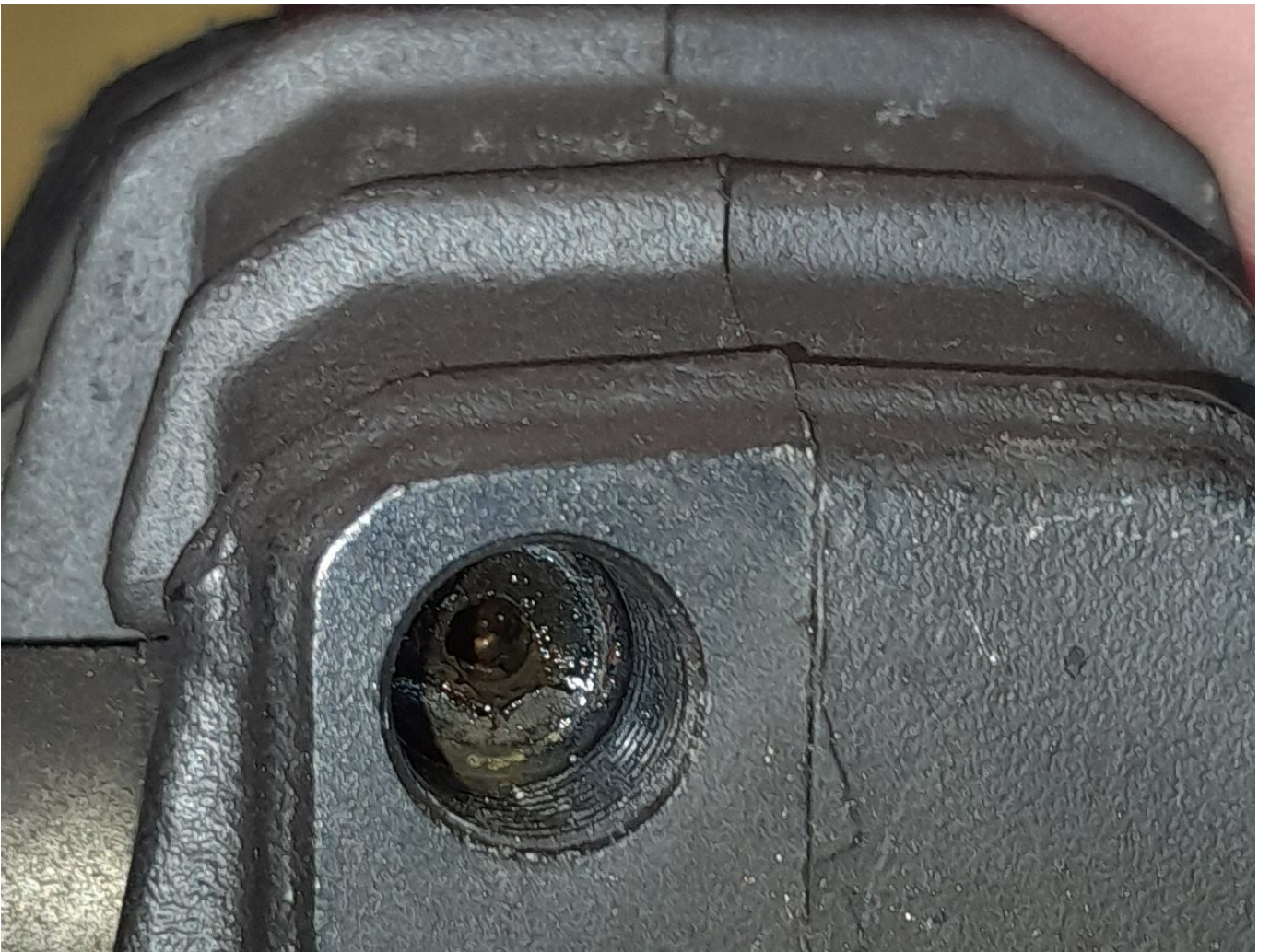
L'orifice de fixation de la durite dans l'étrier.
