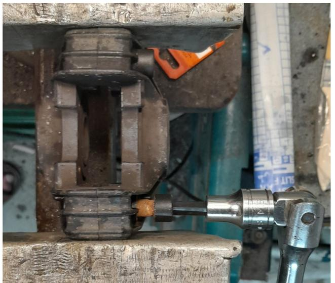
En essayant de débloquer la vis restante , la douille Facom de 8 mm en bon acier se met à tourner dans la tête de la BTR en acier à ferrer les ânes.
