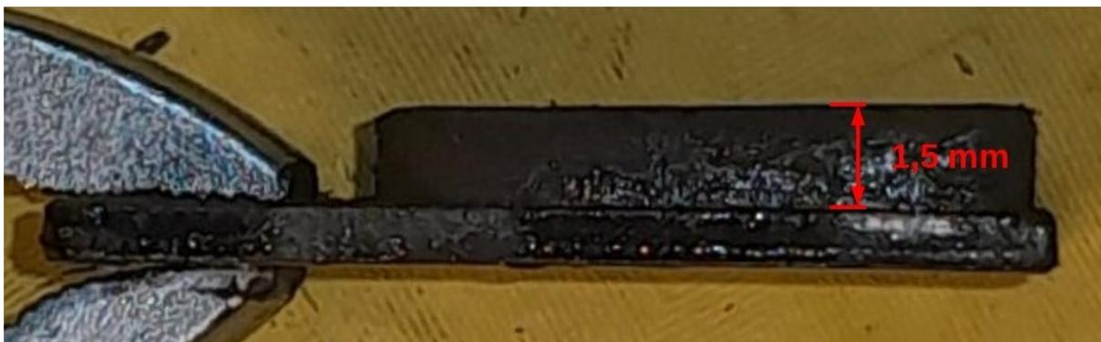
Vérifiez l'épaisseur du disque qui doit être supérieure à 3,55 mm
