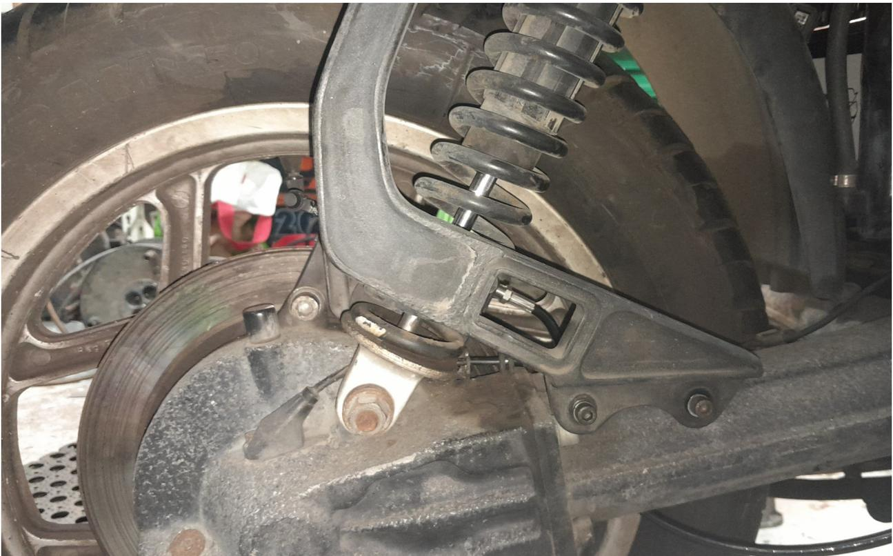
Je pense donc préférable de démonter systématiquement la roue arrière pour avoir un bon accès à l'étrier et ne pas avoir à repousser les pistons avant nettoyage.
