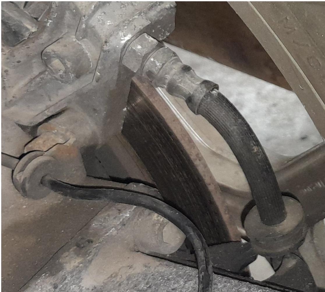
Le raccord arrière sur l'étrier de frein est un raccord mâle de diamètre 10 mm , pas de 1 mm , convexe et tournant pour permettre le démontage.
