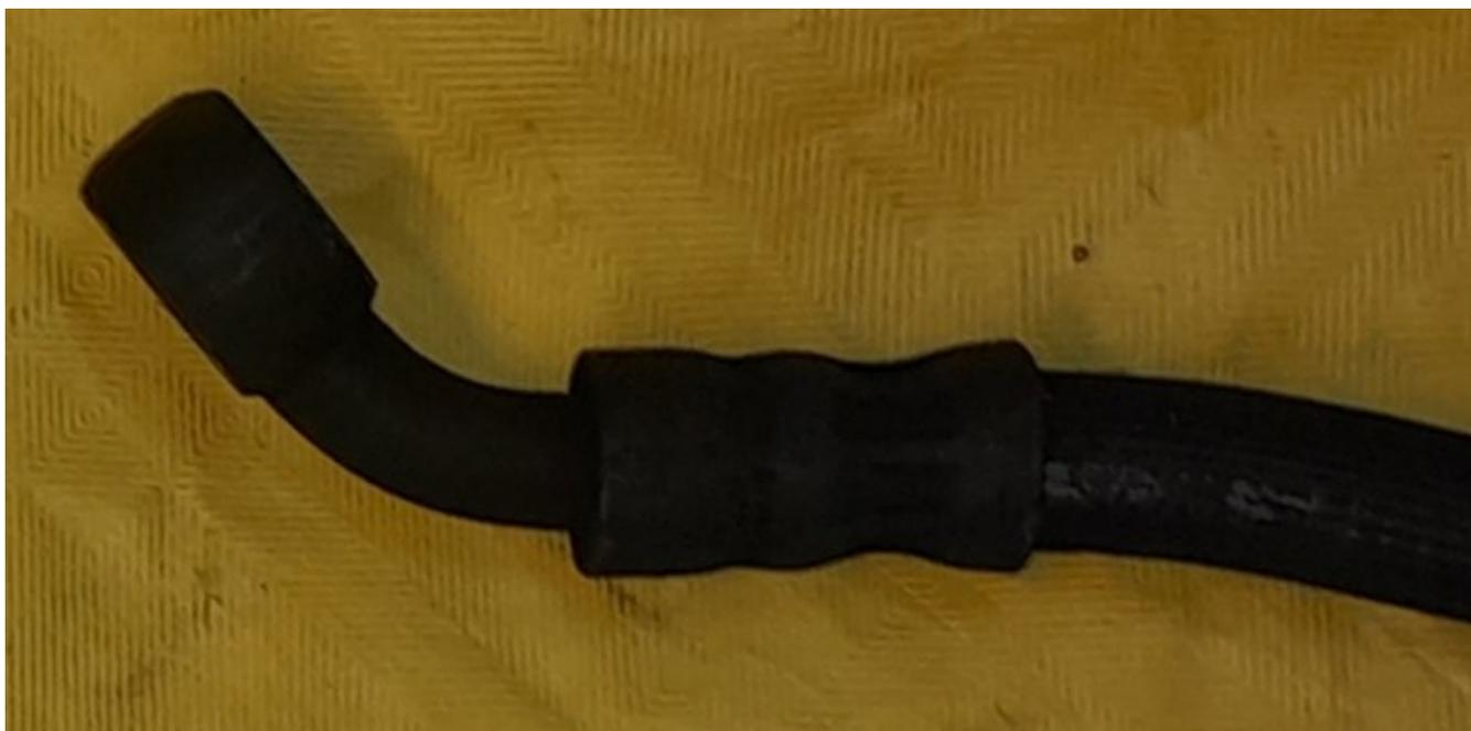
Mettez un sac plastique avec un élastique sur l'extrémité inférieure de la durite pour récupérer le liquide de frein.
