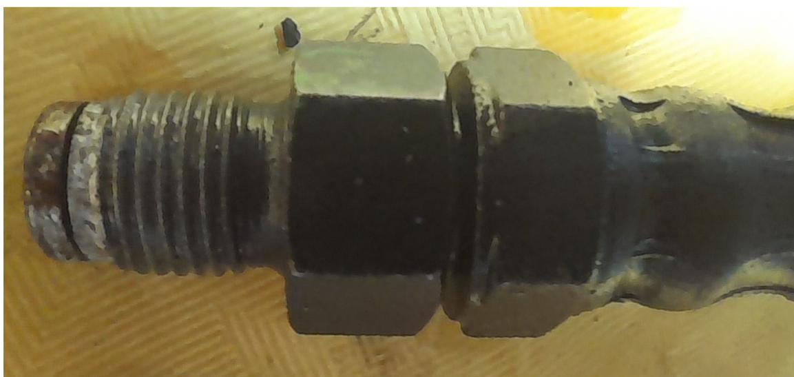
Le taraudage sur la face avant de l'étrier de frein arrière correspond à un raccord femelle concave de diamètre 10 mm , pas de 1 mm.
