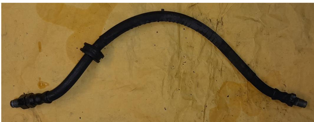
La durite d'une longueur de 41 cm hors tout est munie d'un passe fil caoutchouc qui s'insère dans un support fixé sur le bras oscillant.
