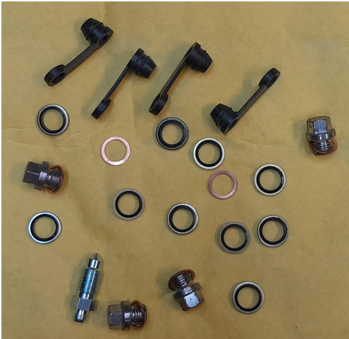
Le lot de petites pièces pas trop coûteuses , c'est l'occasion de remplacer si nécessaire les protections de vis de purge pour faciliter la prochaine purge.
