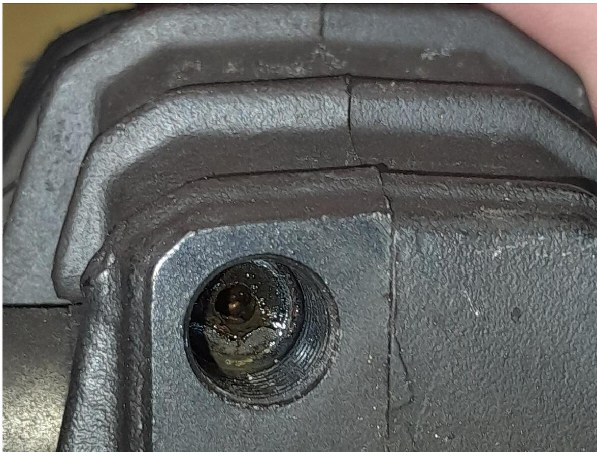
Le taraudage dans le maître cylindre de frein arrière est aussi celui d'un raccord femelle concave de 10 mm de diamètre , pas de 1 mm.
