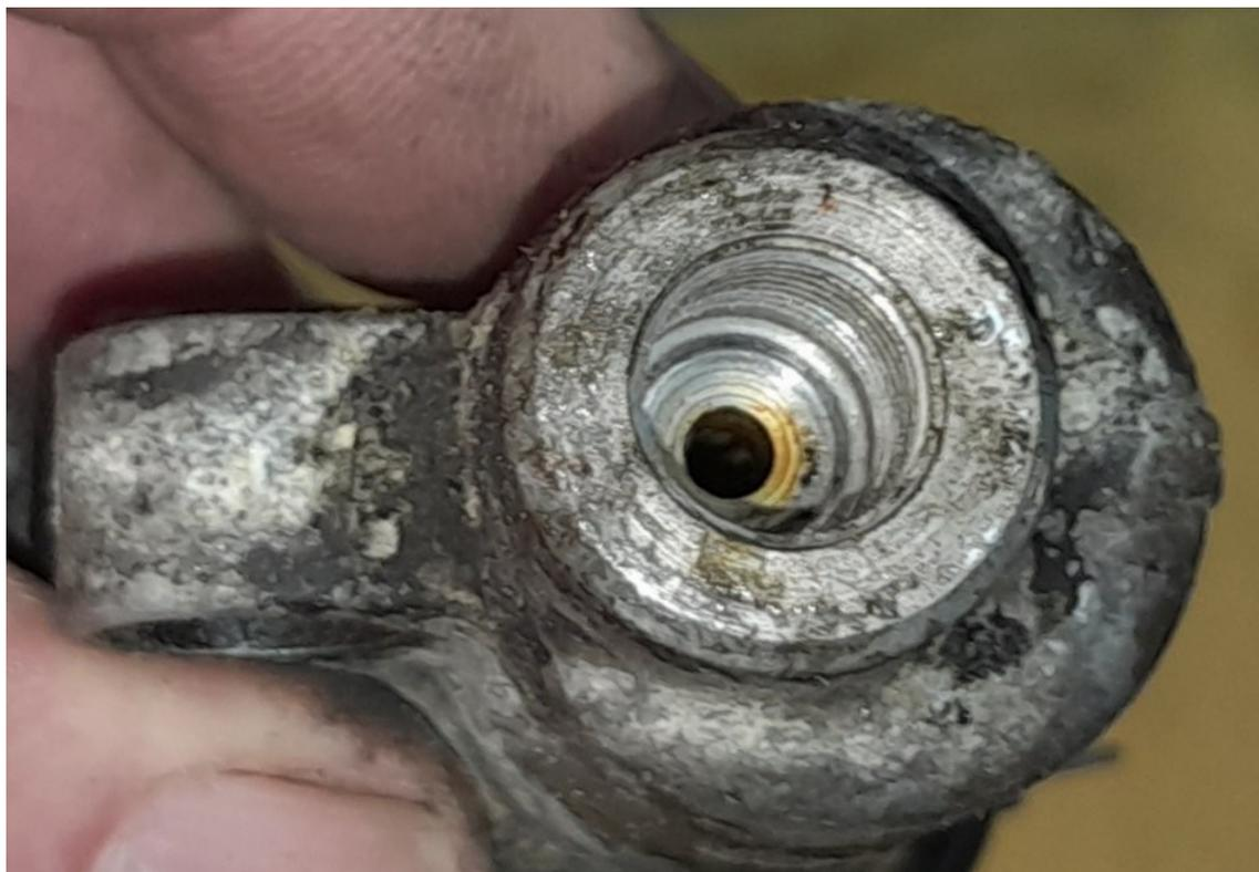
Le raccord avant de la durite sur le maître cylindre de frein arrière est un raccord mâle de diamètre 10 mm , pas de 1 mm , convexe/concave
