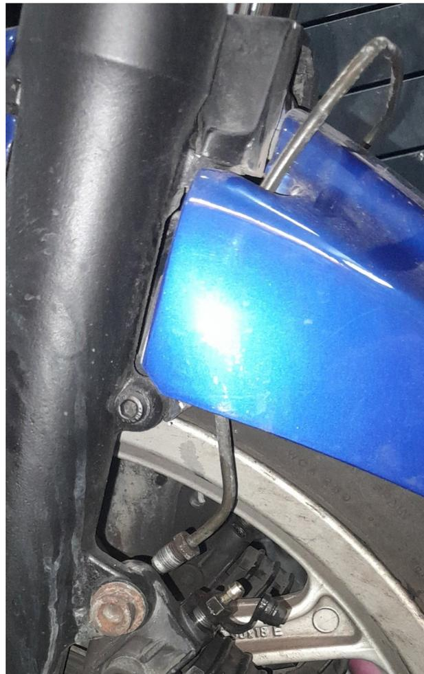
Les taraudages femelles de fixation de ces tuyaux dans les étriers sont au diamètre 10 mm pas de 1 mm , concaves.
