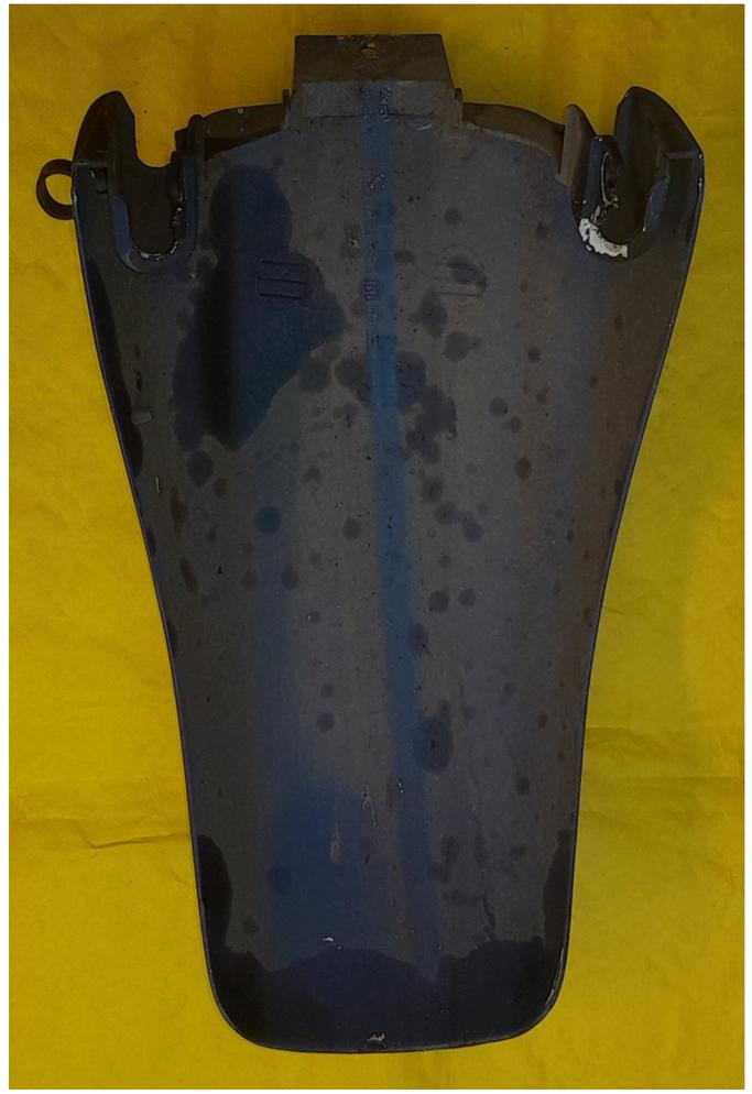
Avec une clé Allen de 5 et une clé à œil de 10 mm , démontez les 4 vis BTR 6x40 fixant les deux moitiés du garde boue sur les fourreaux de fourche.
