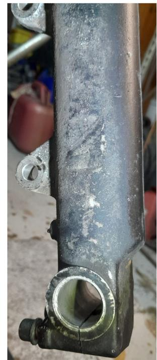
Le remplacement des joints spis est une opération parfois simple mais assez lourde car il faudra déposer le carénage , le phare , les instruments , le tableau de bord , les étriers , la roue avant , le garde boue avant , et déshabiller complètement la fourche.
