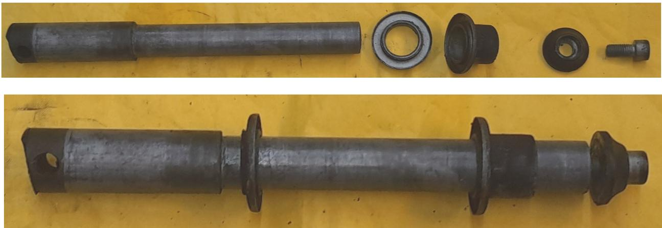
Sortez la roue et remettez y l'axe avec les entretoises , la rondelle et la vis d'extrémité.
