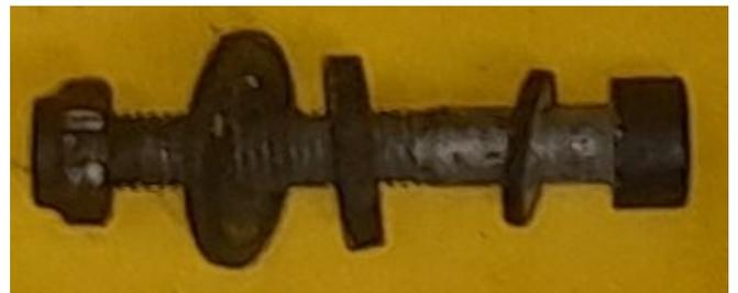
Les vis arrières disposent d'une rondelle épaisse supplémentaire entre fourreau et garde boue.
