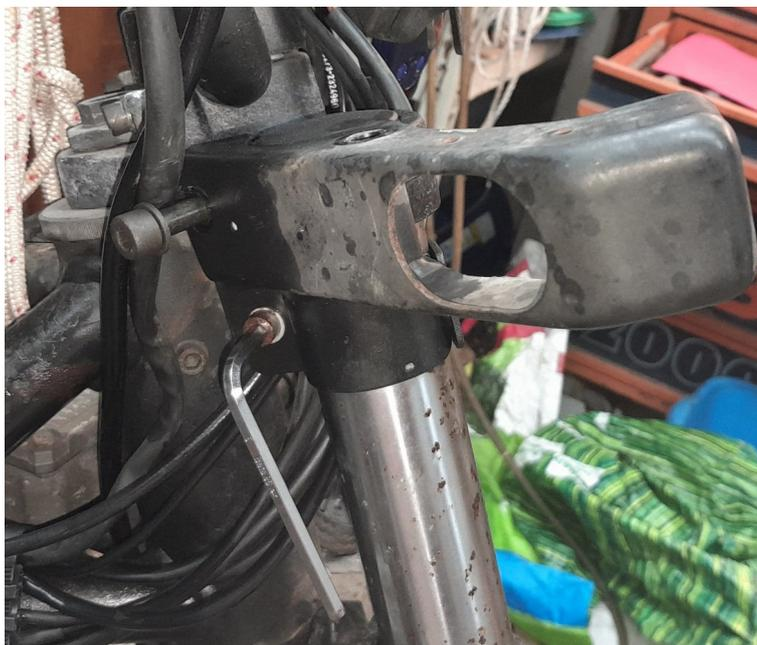
Les vis de bridage des tubes au niveau du T inférieur sont des BTR avec rondelle de 10x45mm donc répétez la même opération mais avec une douille Allen de 8 mm
