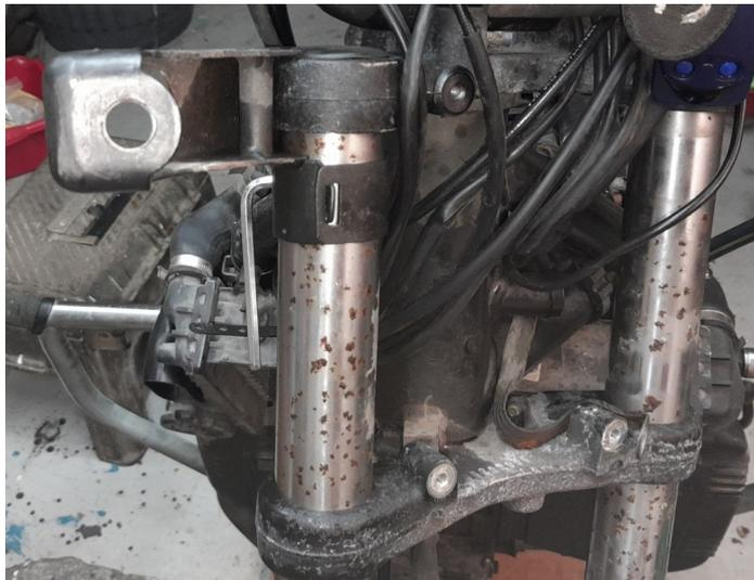
Avec une lame de couteau émoussée retirez les capuchons plastique en haut des tubes de fourche et repérez la position en hauteur des tubes par rapport aux Tés de fourche.
