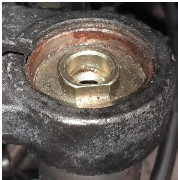
Avec une douille de 6 tapez un coup sec sur les vis BTR 8x50 avec rondelle qui brident les tubes de fourche dans le T supérieur et qui peuvent être difficiles à desserrer , puis dévissez les un peu pour libérer les supports de pare-brise.
