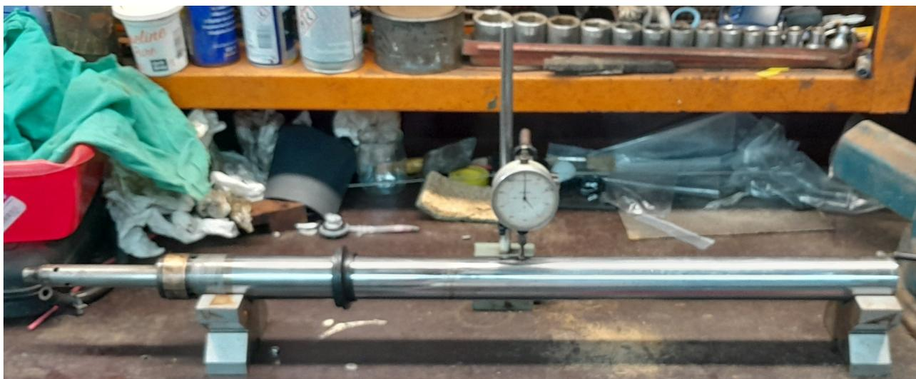
De très fines irrégularités sur la zone de coulissement pourront être éliminées par un ponçage à l'huile avec du papier abrasif à l'eau d'au moins 1000 , mais si les tubes sont abîmés , les joints spis recommenceront rapidement à fuir. Pas d'autre solution que de changer les tubes.
