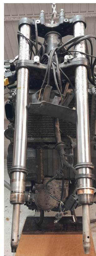
Une fois le fourreau gauche sorti du tube gauche, avec une clé Allen de 6 j'ai démonté les quatre vis de 8x25 avec rondelle du pontet rigidificateur de fourche
