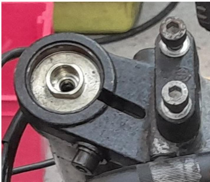
Avec une clé Allen de 8 dévissez les deux vis de 10x45 avec rondelles qui pincent les tubes dans le pontet inférieur.
