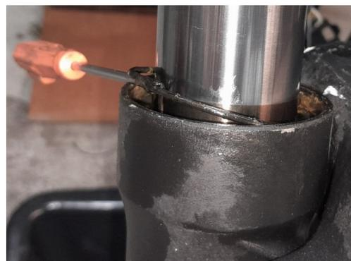
Vous pouvez maintenant théoriquement si tout se passe bien sortir en bloc les deux fourreaux et le pontet de rigidification en les remontant sur les tubes puis en les descendant en butée d'un coup sec.
