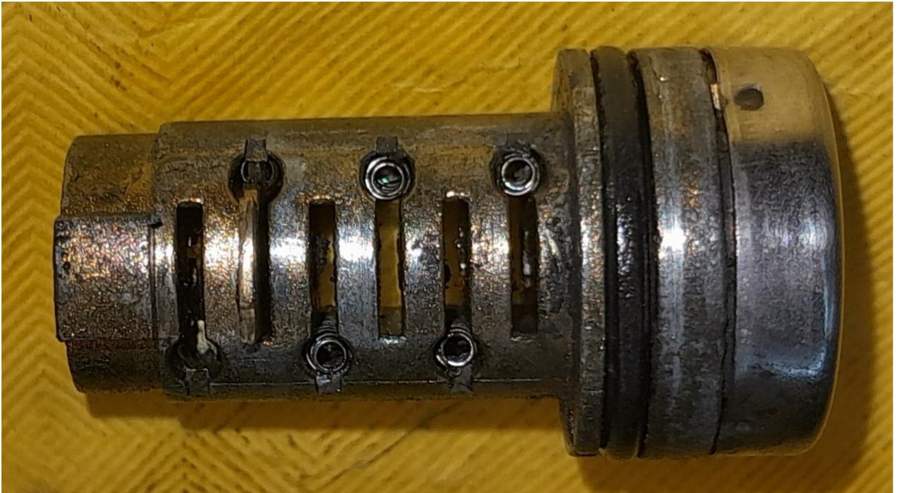
Sur le top case , seules les 4 premières fentes étaient occupées par des paillettes , la 5ème était occupée par la paillette de blocage et la 6 ème était vide , vraisemblablement d'origine puisque le trou pour repousser la paillette de verrouillage est en face de la 5ème paillette.
