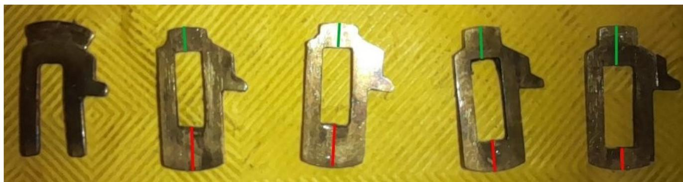
La paillette de gauche, de forme un peu différente, est la paillette de verrouillage, elle a été un peu tordue au cours des manœuvres de démontage et devra être redressée.
