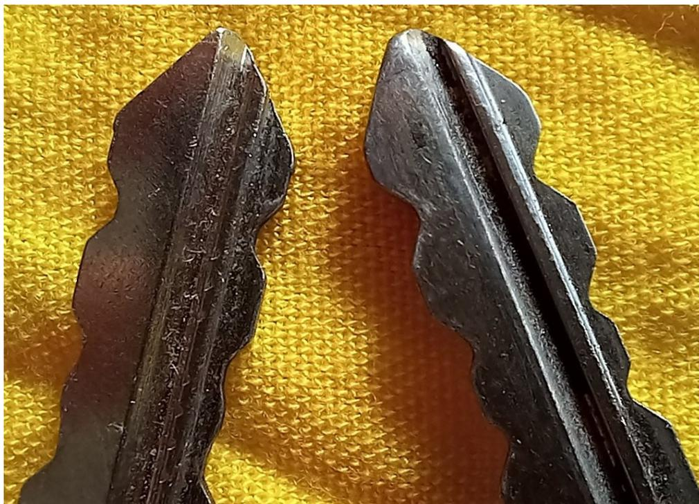
Ces différentes usures peuvent se potentialiser : clé et paillette ou se compenser par une usure du canon sous forme de stries.
