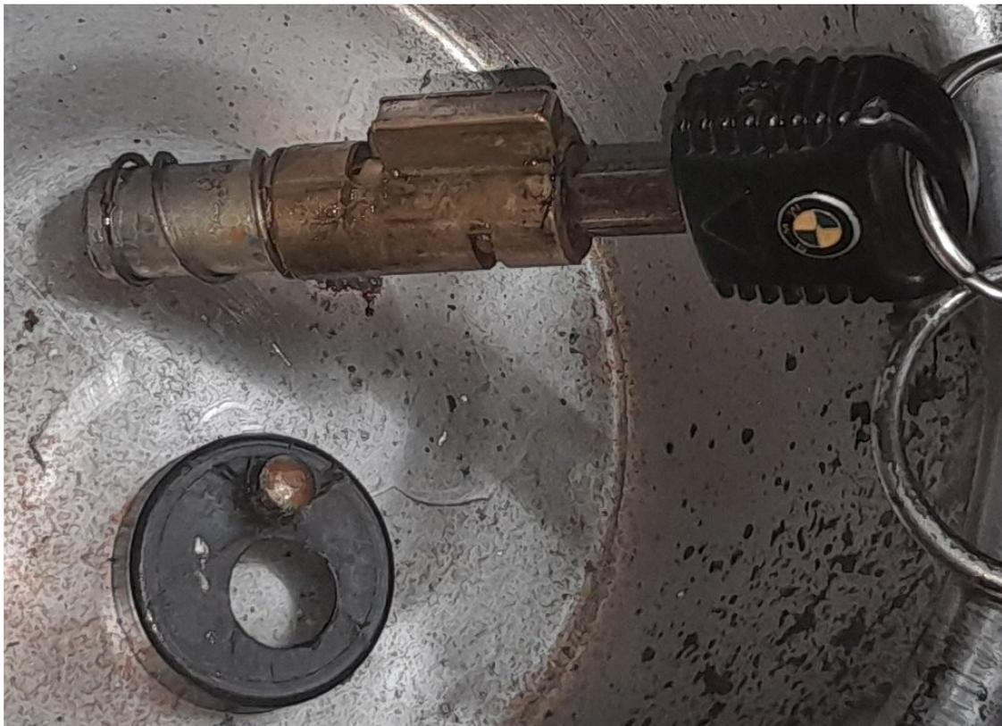
**Barillet de l'interrupteur d'allumage (identique à celui du bouchon d'essence).**
