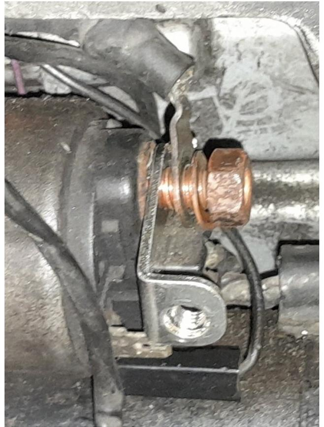
Remplacez cette pièce par la pièce en L fournie avec la nouvelle borne , remontez la cosse ,la rondelle et l'écrou et serrez l'écrou au couple de 10 Nm en maintenant la pièce en L pour qu'elle ne soit en butée ni dans un sens ni dans l'autre (pour avoir une légère possibilité d'ajustement ensuite en cas de mauvais perçage en hauteur).
