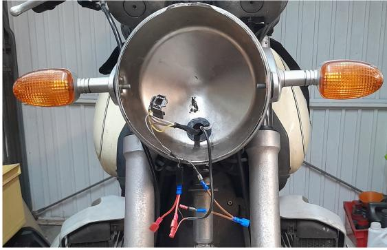
Comme je ne roule pas souvent sous la pluie, je me suis contenté de brancher le faisceau sur les veilleuses pour que l'alimentation soit coupée par le contact (en cas de problème on peut facilement débrancher la prise d'alimentation du support), mais le passage par un fusible et un interrupteur serait certainement préférable.
