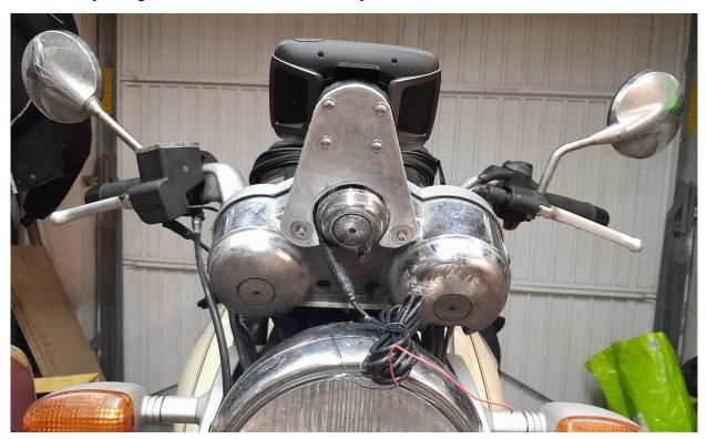
Le support avec verrouillage assurant la connexion électrique automatiquement est pratique. Le système de verrouillage à clé parait un gadget (il vaut mieux retirer complètement le TomTom pour éviter les tentations).
