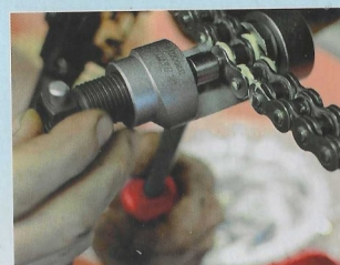
Vernieten der Kette Riveting the chain Rivete de la chaîne
