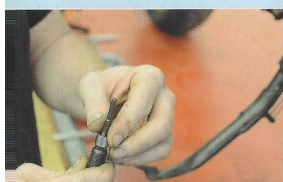
unterschiedlich starke Ausdrück-Dorne different sizes of removal pin chasse-rivets de différentes tailles
