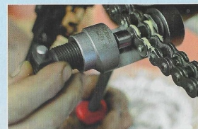
Vernieten der Kette Riveting the chain Rivete de la chaîne
